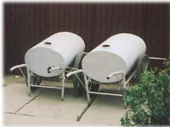
图 2-15 现场洒水设备
